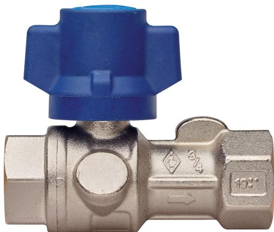
Vanne à boisseau sphérique de sortie compteur de l'eau, à passage total, taraudée F/F, anti-retour incorporé, avec poignée anti-violation, sans raccords pression et sphère avec système automatique de rinçage.
