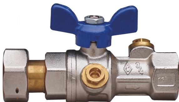
Vanne à boisseau sphérique de sortie compteur de l'eau à passage total, taraudée femelle/raccord, anti retour incorporé, raccord pression, poignée papillon en aluminium et sphère avec système automatique de rinçage.
