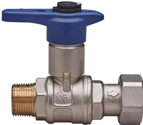
Vanne à boisseau sphérique d'entrée compteur de l'eau, passage total, taraudée male/raccord, poignée en tecnopolymère, serrure de sécurité extractable et remplaçable et sphère avec système automatique de rinçage.
