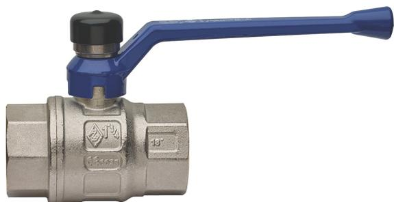
Vanne à boisseau sphérique d'entrée compteur d'eau, à passage total, taraudée F/F, avec poignée en aluminium, bloc anti-violation et sphère avec système de rinçage automatique.
