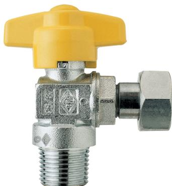
Robinet à boisseau sphérique pour gaz à équerre, taraudée mâle, avec écrou de raccord, poignée à papillon en aluminium, fermeture avec déclic de sécurité.
