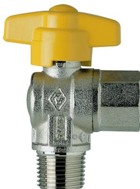
Robinet à boisseau sphérique pour gaz à équerre, taraudée mâle, avec connexion femelle pour tuyau flexible métallique UNI EN 14800, poignée à papillon en aluminium, fermeture avec déclic de sécurité.
