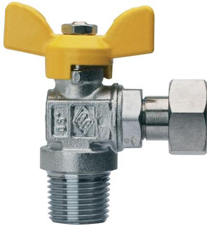
Robinet à boisseau sphérique pour gaz, à équerre, taraudée mâle avec écrou et poignée à papillon en aluminium.
