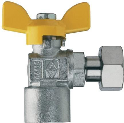
Robinet à boisseau sphérique pour gaz, à équerre, taraudée femelle avec écrou et poignée à papillon en aluminium.
