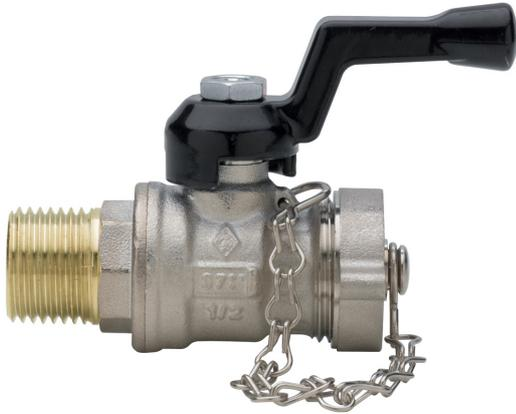
Robinet à boisseau sphérique de vidange pour chaudière nickelée, taraudée male, avec levier en aluminium, bouchon et chaînette.
