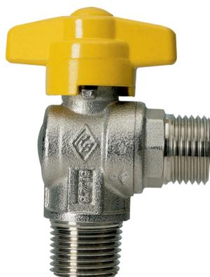
Válvula esfera por gas escuadra, rosca macho con conexión macho por tubo metálico UNI EN 14800, mariposa en aluminio con arrebato de seguridad en cierre.
