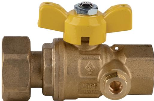
Valvula esfera a paso total, después medidor con sistema de medición de la presión en seguridad, conexiones tuerca de 1"/rosca hembra y mariposa en aluminio.
