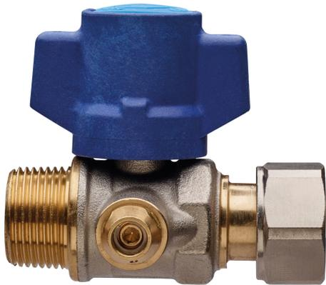
Válvula esfera a paso total para medidor de agua, extremo macho/tuerca loca, palanca anti-manipulación, con mínimo vital y esfera con sistema de aclarado automático.
