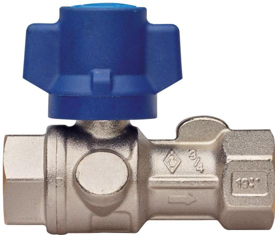
Kugelhahn für Wasserzähleranschluss, mit vollem Durchgang, Innengewinde, mit eingebautem Rückschlagventil, mit manipulationssicherem Flügelgriff und Edelstahl Sicherheitsmutter, Kugel mit automatischem Spülsystem.
