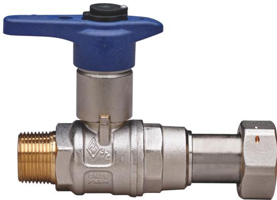
Kugelhahn für den Eingang des Trinkwasserzählers, voller Durchgang, einerseits Aussengewinde, andererseits Teleskopverschraubung, Griff aus Technopolymer mit verriegelbarem und austauschbarem Schloss, Kugel mit automatischer Hinterspülung.
