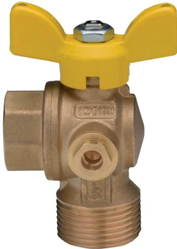
Eck-Kugelhahn voller Durchgang, Montage nach dem Zähler, mit Anschluss für Druckmessung, einerseits Innengewinde, andererseits Aussengewinde, mit Flügelgriff.
