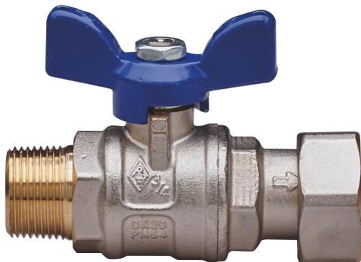
Vanne à boisseau sphérique d'entrée compteur de l'eau, passage total, taraudée male/raccord, poignée papillon en aluminium et sphère avec système automatique de rinçage.
